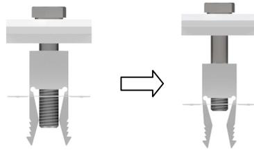
**Passo 2:** Inserir o Grampo no Perfil – Faça uma leve pressão para aproximar as pernas do grampo, se necessário. Pressione o grampo contra o perfil.
