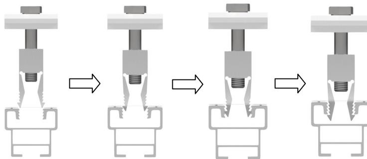
**Passo 3:** Inserir o Parafuso – Desça o parafuso para que os dentes do grampo façam contato com os dentes do perfil.
