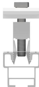
**Atenção:** Jamais inserir os Grampos no Perfil com o Parafuso causando interferência.
